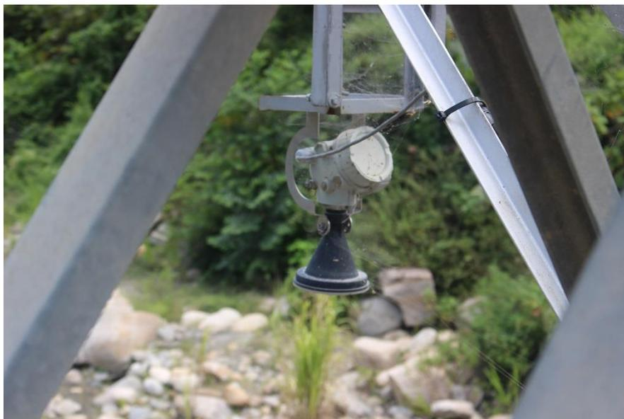
**Figura 8.** Radar hidrológico con sistema de transmisión sinistrado
