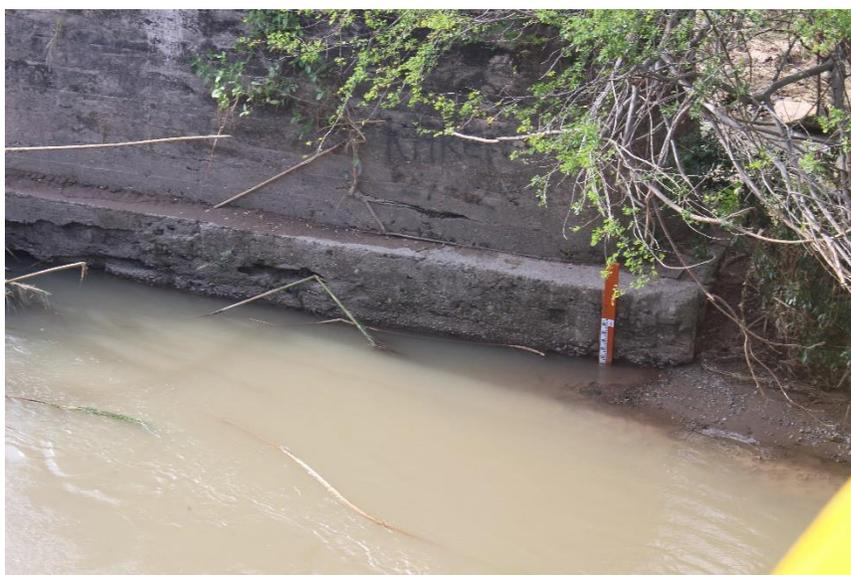
**Figura 29.** Limnimetro sobre el Río Aipe.
