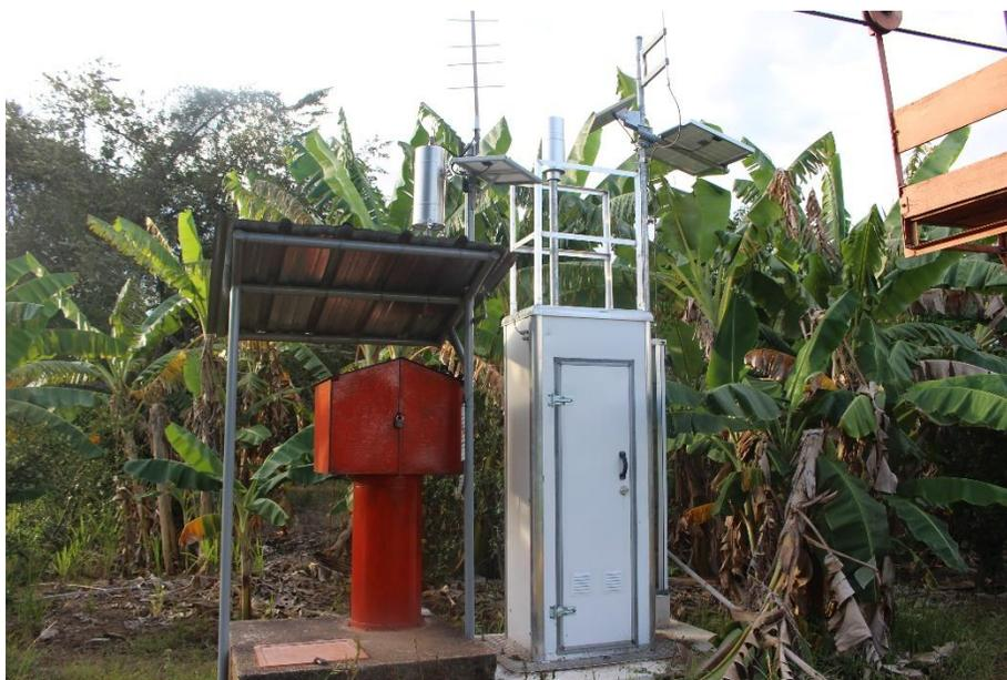
**Figura 19.** Estación automática La esperanza IDEAM- Fondo de Adaptación sobre el Río Magdalena. A la izquierda de la estación se encuentra una caseta con un limnigrafo y en el borde superior derecho se alcanza a observar la tarabita para la realización de aforos.
