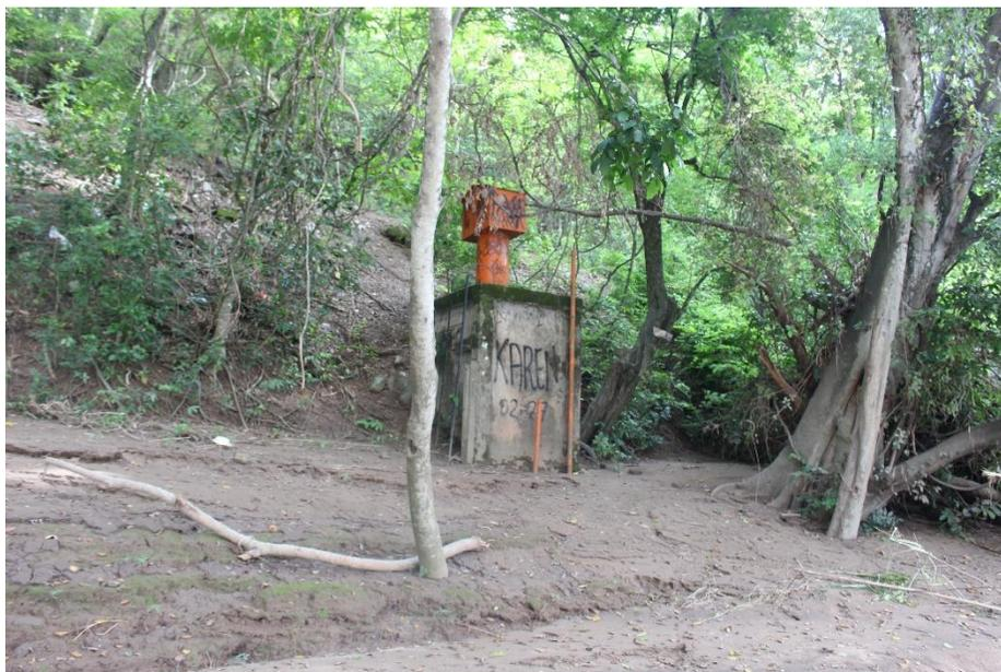
**Figura 28.** Limnigrafo con maxímetro sobre el Río Aipe
